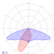
STA Niedrige Lichtpunkthöhe, große Mastabstände
